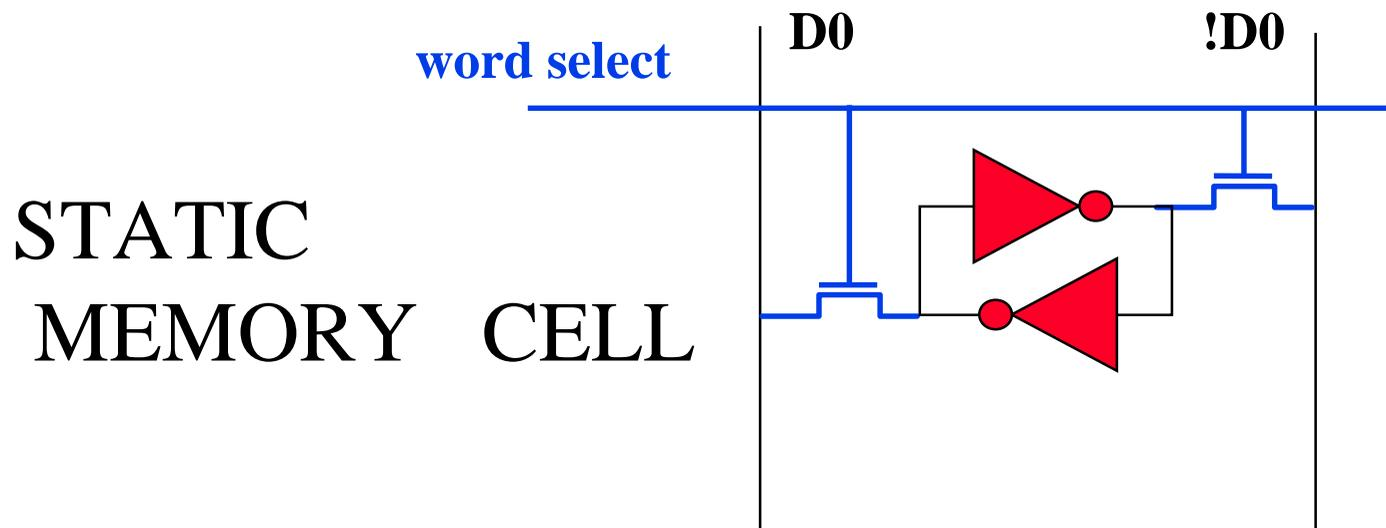
**THE BASIC ELEMENT IS A STATIC LATCH THAT HOLDS THE STORED VALUE AS LONG THE POWER IS ON.**
